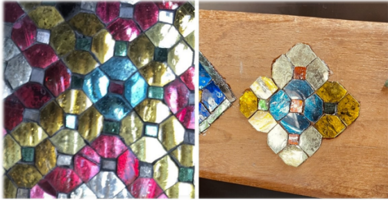
ภาพที่ 4 การทดลองประดับกระจกเกรียบที่ประดิษฐ์ขึ้นใหม่เป็นลายเกล็ดเต่าลายโคม เลียนแบบลายที่เสาบริเวณระเบียงหลังพระอุโบสถ วัดพระศรีรัตนศาสดาราม
