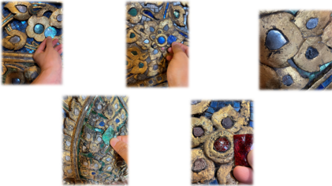
ภาพที่ 47 การสำรวจและเก็บตัวอย่างกระจกเกรียบประดับลวดลายปูนปั้นพระเขนย พระพุทธไสยาสน์ วัดพระเชตุพนวิมลมังคลาราม
